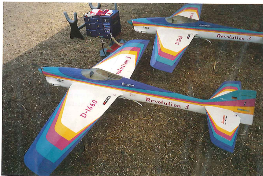
Günther Ulsamers Revolution 3 wog 4,7 kg und war mit einem OS FS-120S-SP ausgerüstet. Propeller: APC 14,3×13. RC-Anlage: Graupner-JR (Pultsender). Ulsamer wurde 11.
