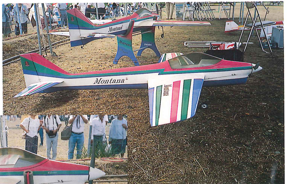
Das Modell Montana von Peter Erang, Deutschland (9. Rang), gehörte mit seinen mehr als 4,8 kg zu den schwereren Brocken des Spitzenfeldes. Motor OS FS-120-SP. Propeller APC 14,4×13. RC Robbe-Futaba.
