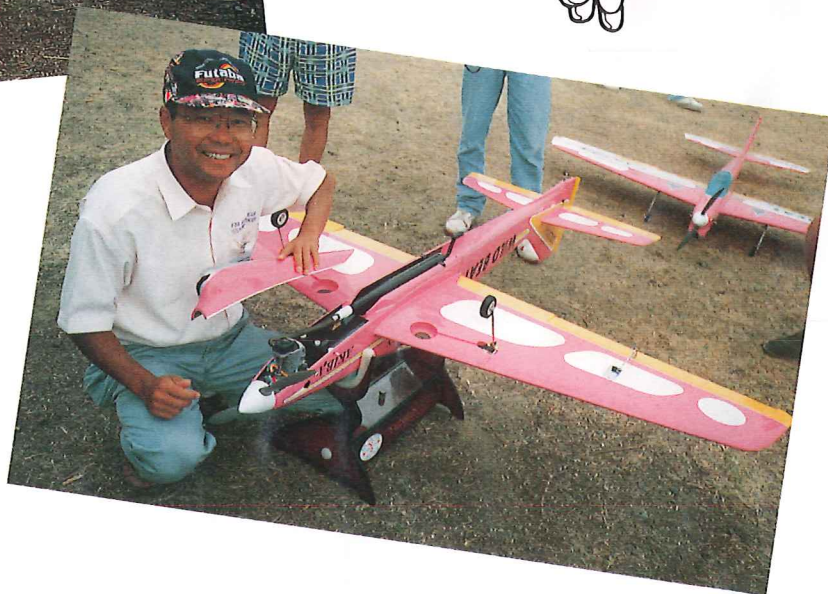
Yoichiro Akiba, Japan (5. Rang), mit dem etwas über 4,3 kg schweren Wild Beat. Motor YS F-120 SC. Propeller APC 15×12.
