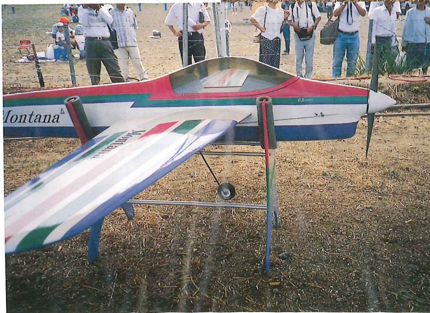
Das Modell Montana von Peter Erang, Deutschland (9. Rang), gehörte mit seinen mehr als 4,8 kg zu den schwereren Brocken des Spitzenfeldes. Motor OS FS-120-SP. Propeller APC 14,4×13. RC Robbe-Futaba.
