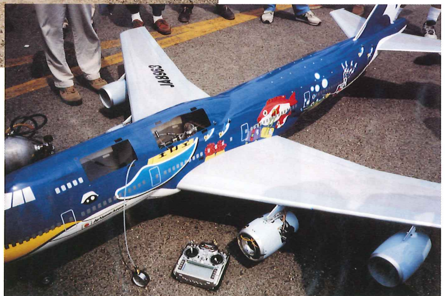
Der bekannte Jumbo-Jet während der Startvorbereitungen. Zwei selbstgebaute Triebwerke und Giezendanner-Einziehfahrwerk.
