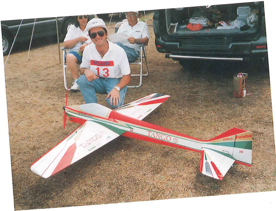
Quique Somenzini, Argentinien (8. Rang), mit seinem knapp 4 kg schweren Tango. Auch er verwendete einen Yamada-Motor (SC) mit einem Riesen-Propeller: APC 17×12!
